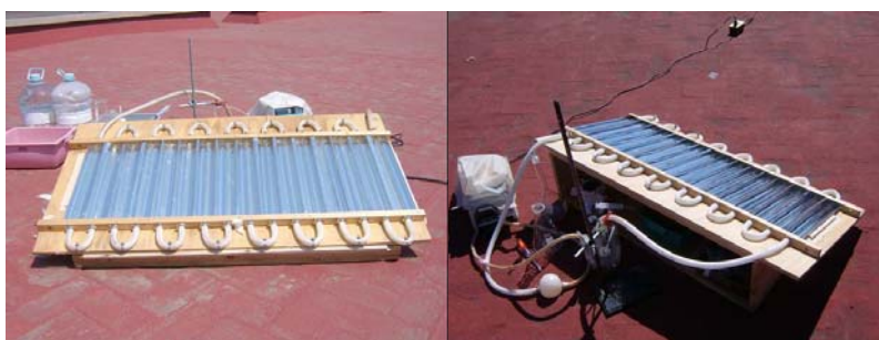
Figura 16. Circuito de flujo cerrado CPC en operación. Reactor B.
