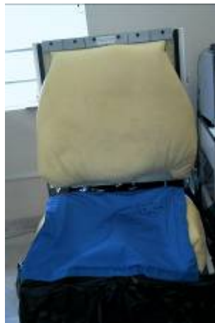
Figura 4.2 Simulador de asientos y tapete Force Sensory Array (FSA)
