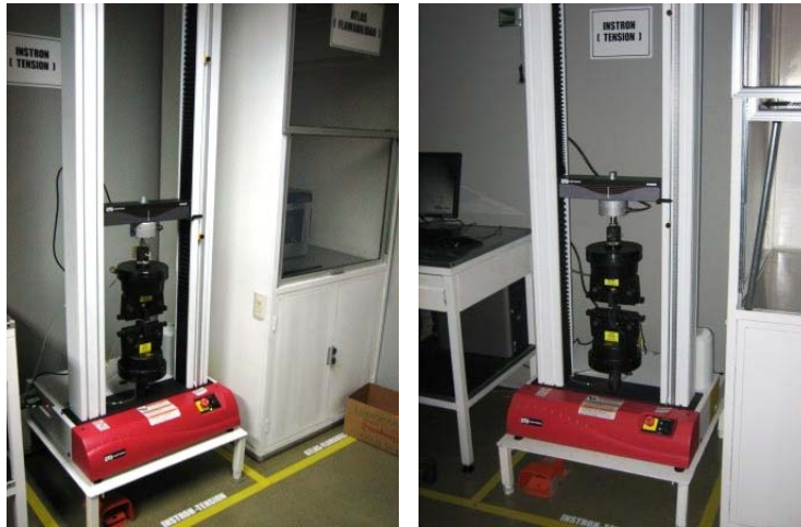
Figura No. 4.3 Máquina Instron para prueba de Adhesión de tapetes.
