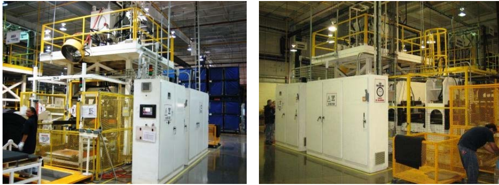
Figura No. 4.8 Prensa de termo formado para tapetes, operación 20.
