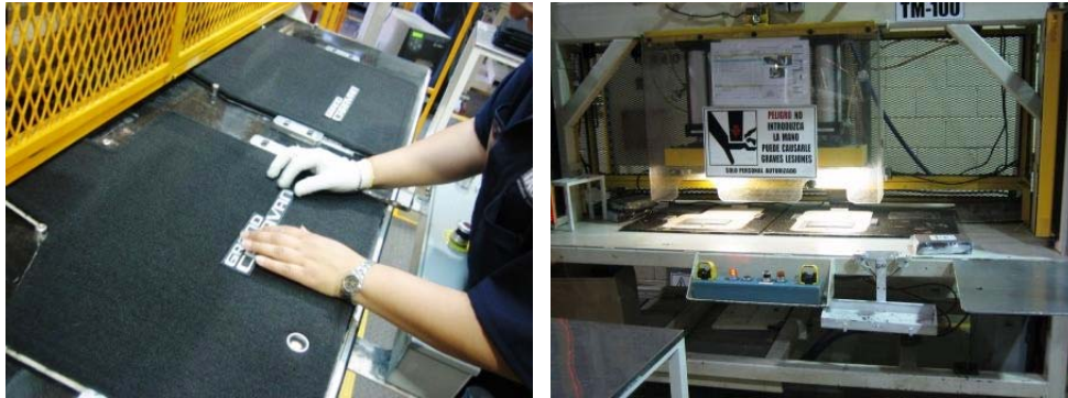
Figura No. 4.12 Máquina soldadora de logotipo, operación 50.
