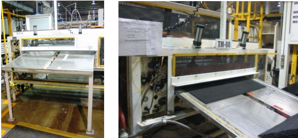
Figura No. 4.9 Máquina para corte de alfombra de tapetes, operación 10.
