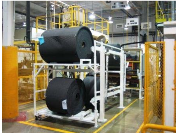
Figura No. 4.7 Alimentación de rollos de alfombra para corte, operación 10.
