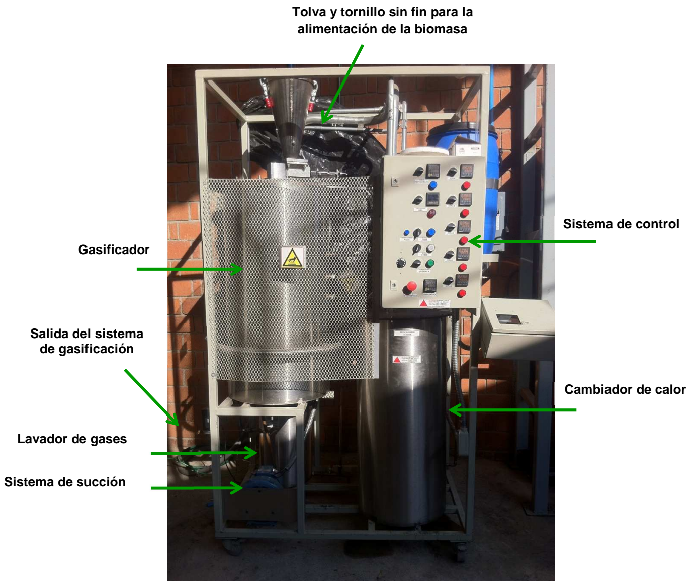
Figura 2.3. Sistema de gasificación de estiércol de ganado bovino.
