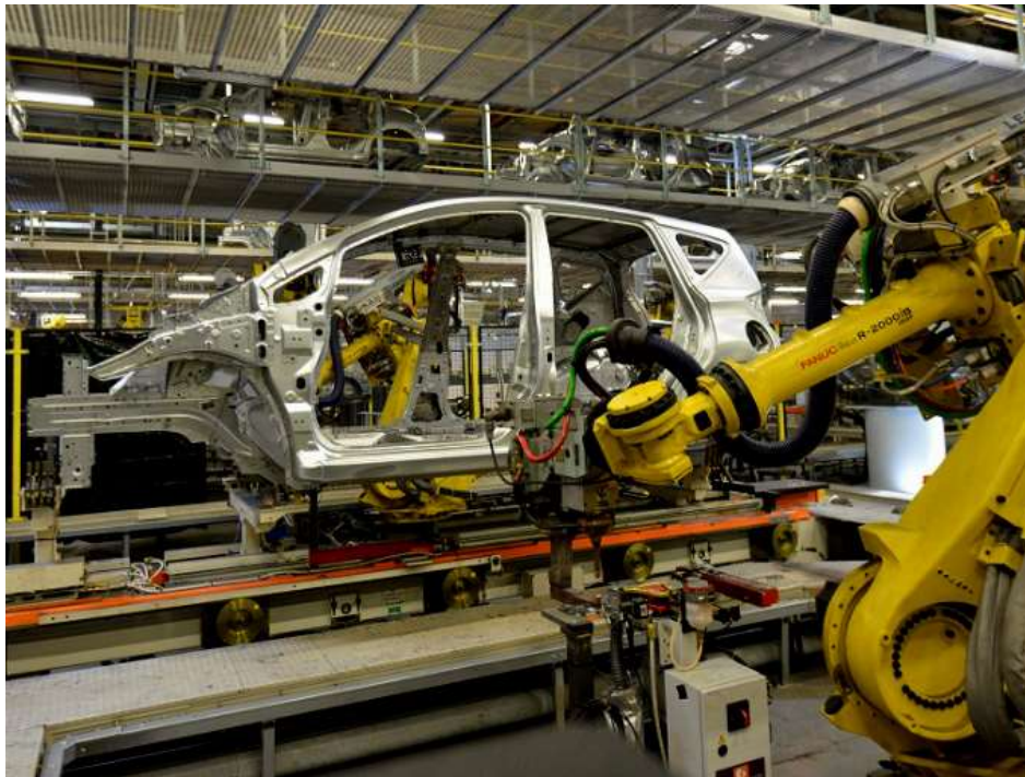
Imagen 18. Proceso automatizado para la producción de automóviles 28
