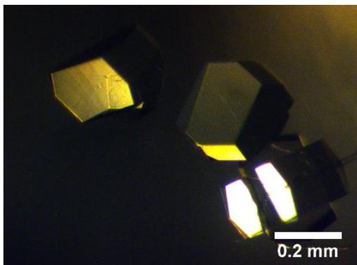
**Figura 28 |** Lisozima y nanopartículas de oro: 5  $\mu\text{L}$  de lisozima a 75 mg/mL en 0.1 M de acetato de sodio (a pH 4.5), 5  $\mu\text{L}$  de nanopartículas de oro de 18 nm estabilizadas en citrato de sodio y 10  $\mu\text{L}$  de solución de pozo, la cual contiene NaCl 6.5% (p/v) en 0.1 M de acetato de sodio a pH 4.5.
