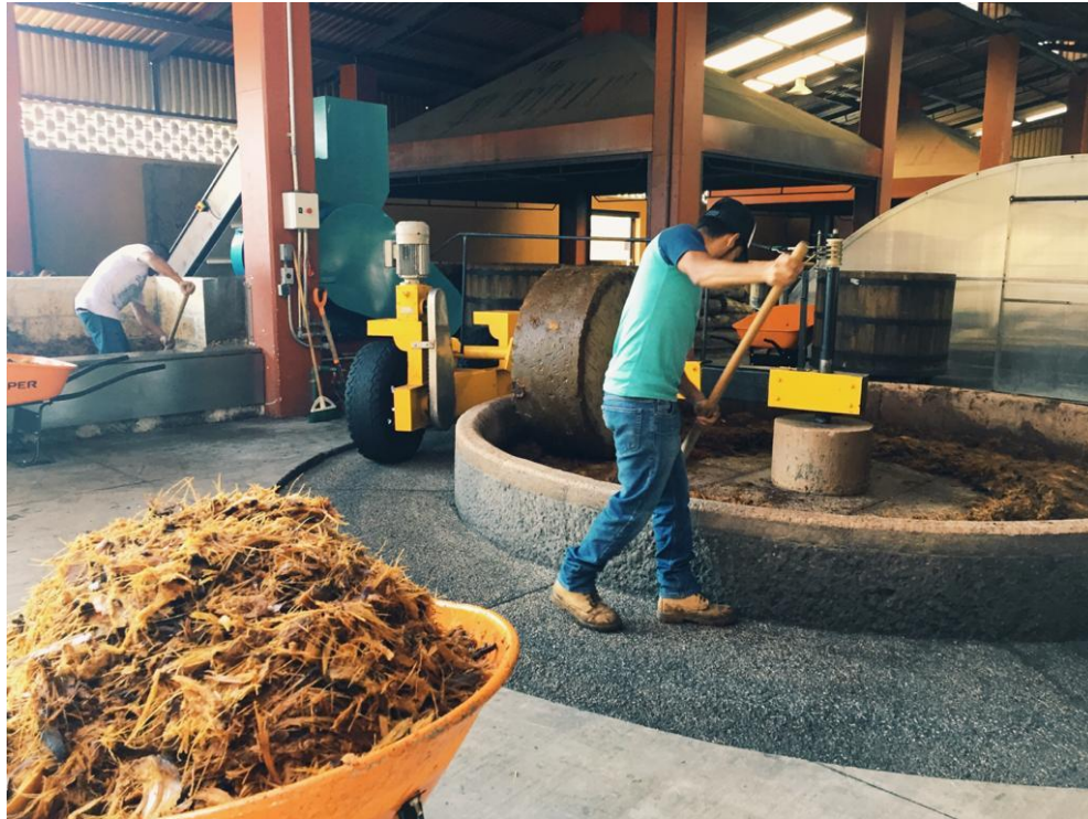
Imagen 30: Tahona en planta de producción de Mezcal Sombra
