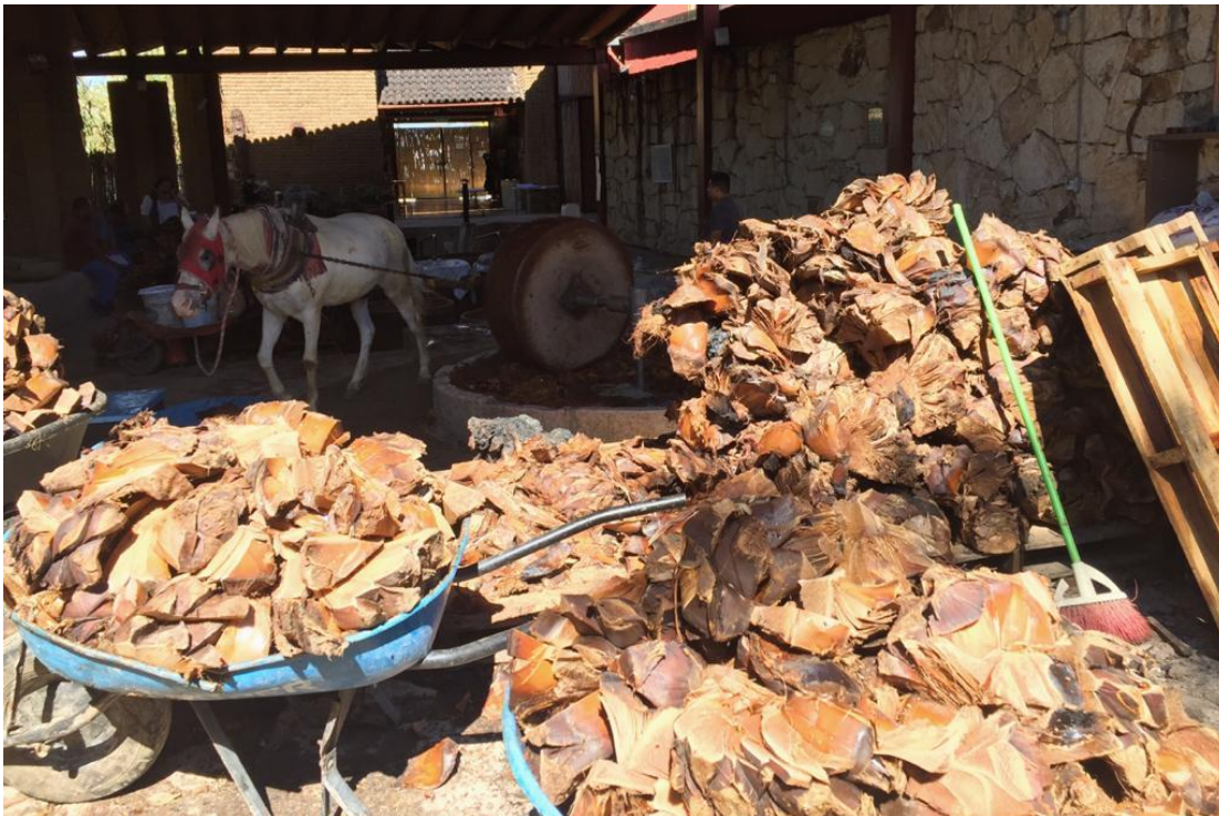
Imagen 12: . Molienda de agave en la destilería los Danzantes mediante el método de Tahona
