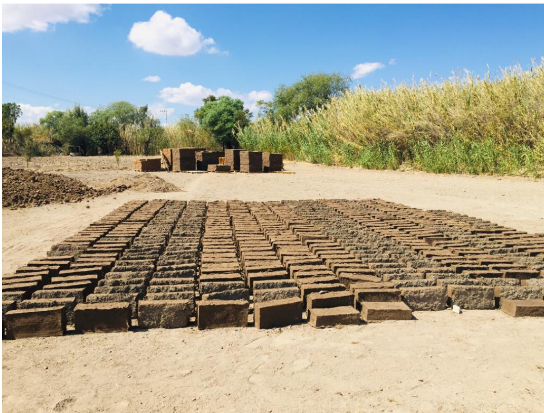
Imagen 31: Adobes elaborados con residuos de la producción de mezcal como la vinaza, fibras de maguey y diversas variedades de tierra. Los adobes son implementados en la construcción de viviendas
