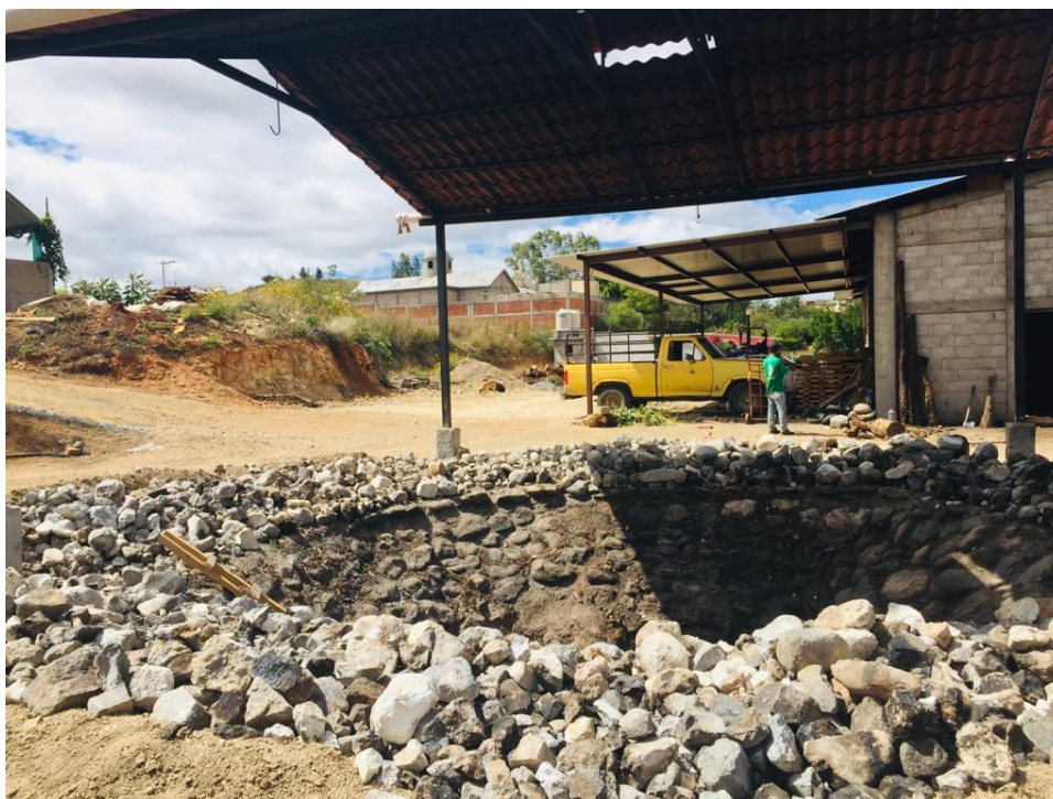
Imagen 11: Horno cónico de suelo en la localidad de Miahuatlán
