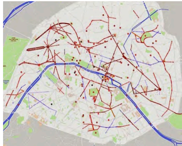
Los bulevares proyectados (línea roja punteada) y construidos (línea roja sólida) en tiempos de Haussmann y los proyectados (línea azul punteada) y construidos (línea azul sólida) con posterioridad
