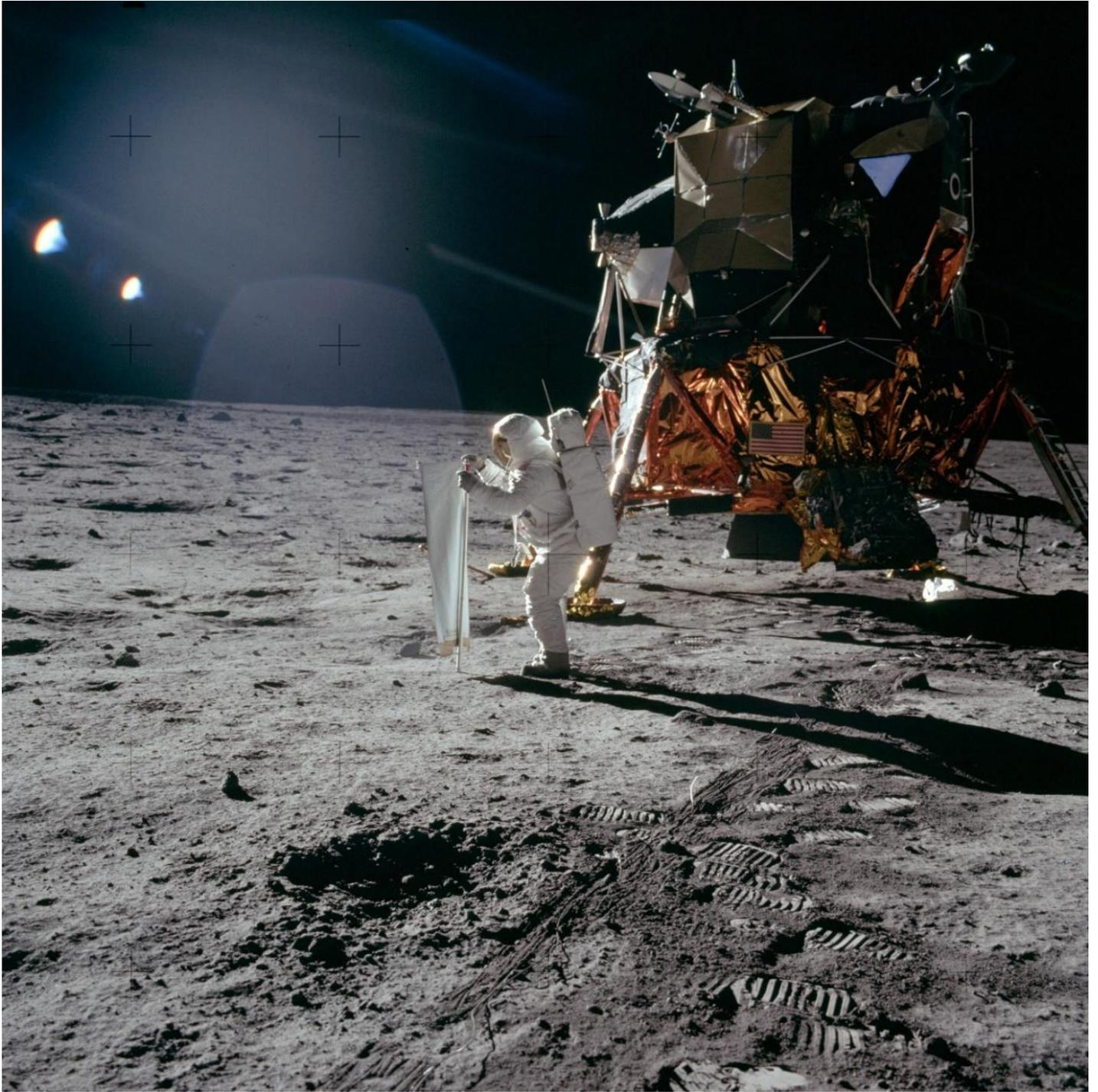
Fig. 1. Fotografía AS11-40-5872. “Buzz” Aldrin desplegando el SWC (Solar Wind Collector, Colector de Viento Solar)
