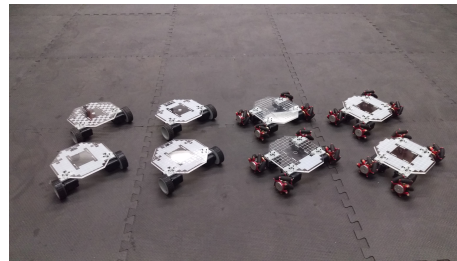
(b) Robots uniclo y omnidireccional construidos en acrílico
