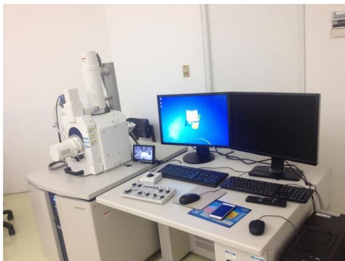
**FIGURA 8 Microscopio Electrónico de Barrido en el laboratorio de la Universidad Iberoamericana**
