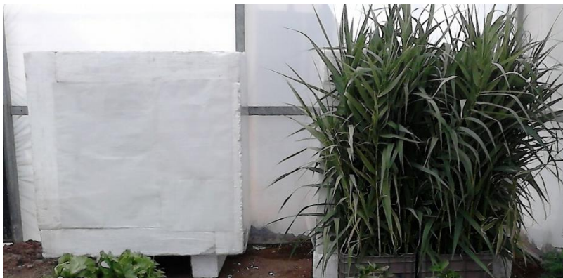
Figura 7.4: Calorímetros "T" al interior del invernadero orientados hacia el este
