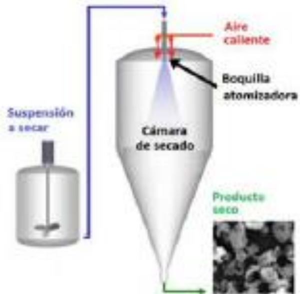
Figura 13: Técnica de micro encapsulación por atomización.
